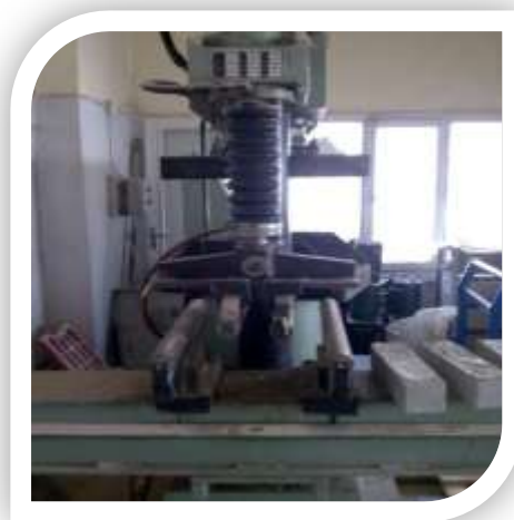
Fig. III.15 Essai de traction par flexion Fig. III.16 Machine d'essai de traction par flexion
