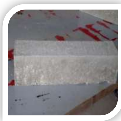
Fig. III.18 Eprouvette 7x7x28 cm
