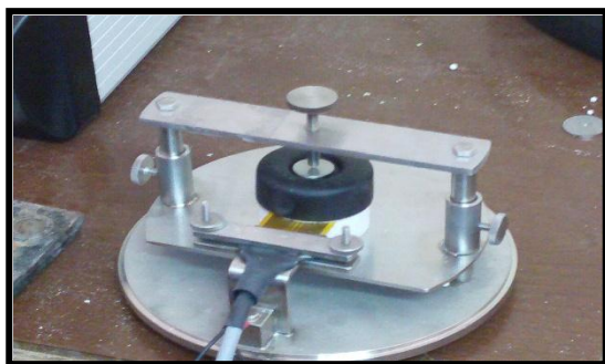
Figure III. 28 : Schéma de la sonde TPS (mesure caractéristiques thermiques du polystyrène).
