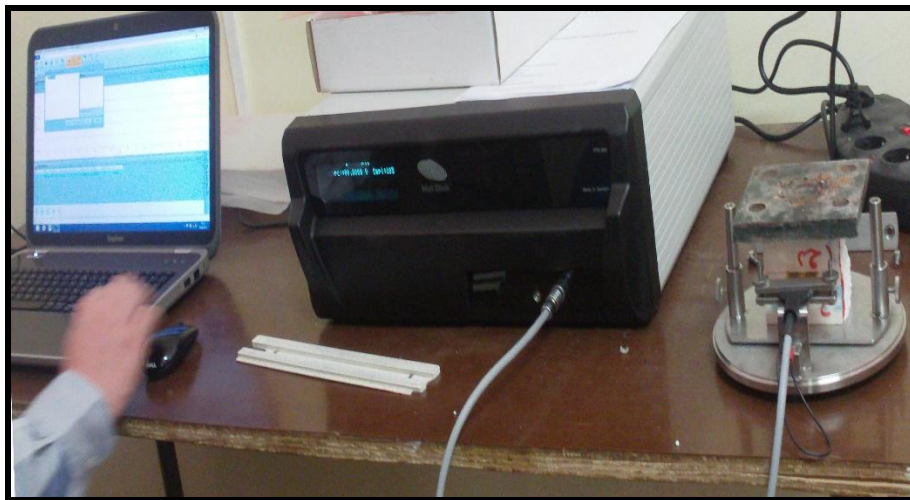
Figure A5 : Dispositif expérimental de la technique TPS.
