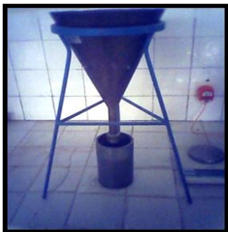
Figure III.6 : Dispositif pour l'essai de récipient et entonnoir à trépied.
