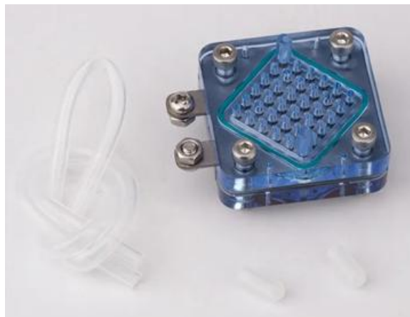
Figure II.1 : photo de la cellule commerciale qui assure le fonctionnement en modes : électrolyseur et Pile à combustible.
