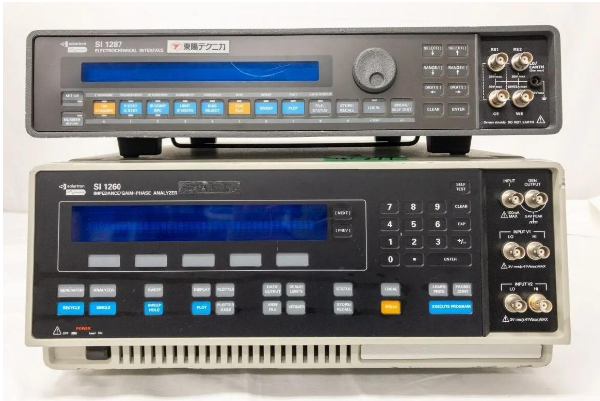
figure II.4 : Dispositif constitué d'un potentiostat modèle Solartron 1287 associé à une impédance mètre de type Solartron 1260.
