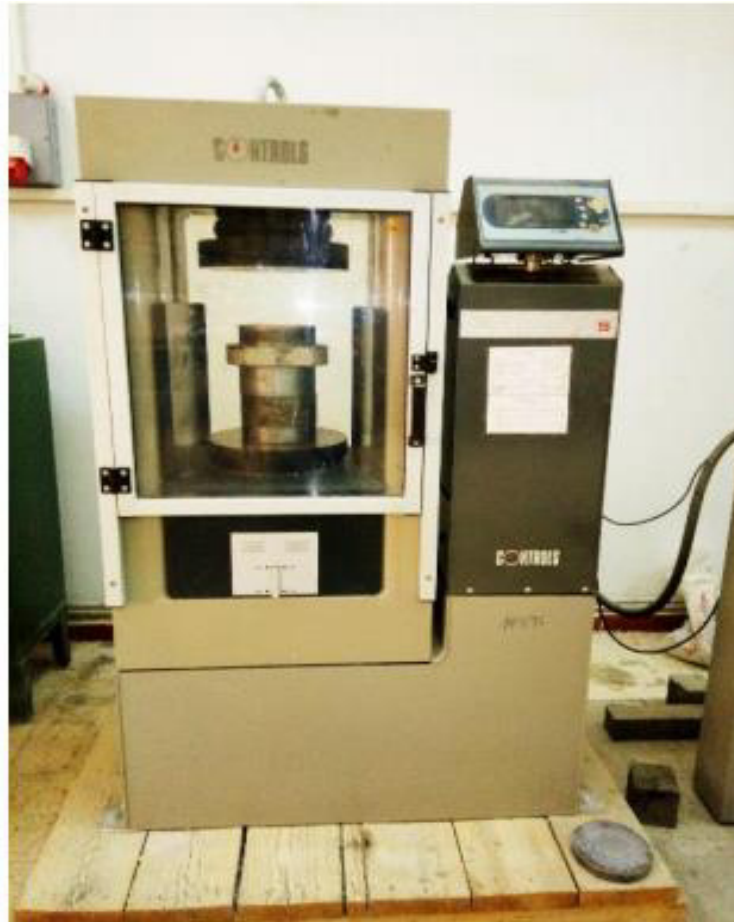
Fig. IV. 5 L'appareil de l'essai de compression
