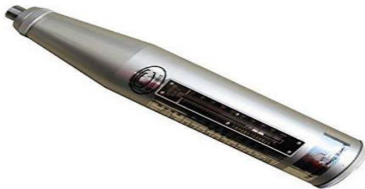
Fig. IV. 8 Marteau de Schmidt ou Scléromètre
