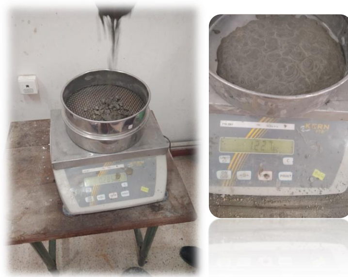
Fig. IV. 4 Essai de la stabilité au tamis
