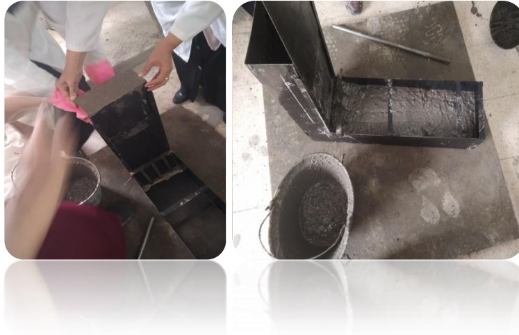
Fig. IV. 3 exemple de l'essai la boîte en L
