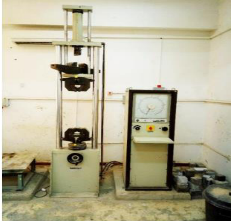
Fig. IV. 6 L'appareil de l'essai de traction par flexion
