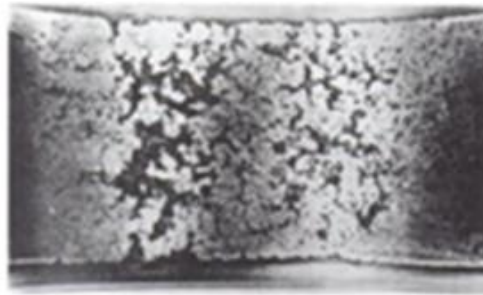
Figure 1-11 : Usure par fatigue d'une bague extérieure d'un roulement à rouleaux cylindriques [6]
