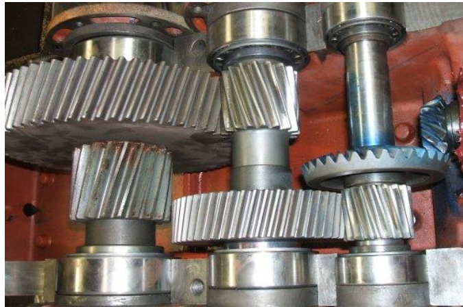
Figure 4-6 : Réducteur à engrenage
