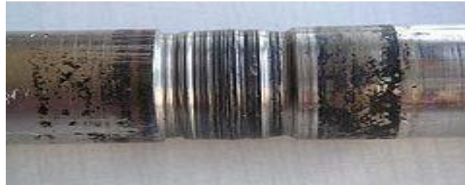
Figure 1-9 : Conséquence de l'usure par abrasion
