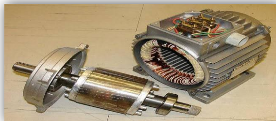
Figure ( II.02) : Constituants de la machines asynchrones
