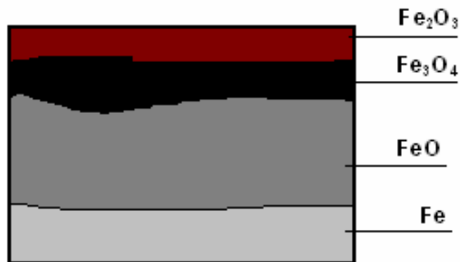
Figure II.27 : Formation des couches d'oxydes superposées sur la surface du fer à 625 °C après 24 h.
