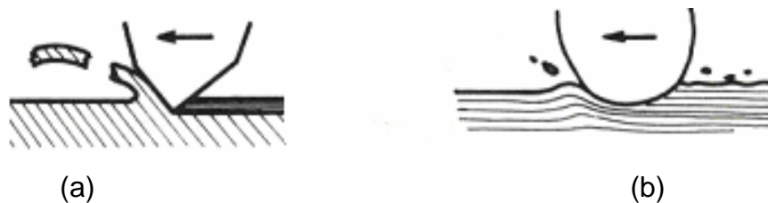
Figure II.22 : Mécanisme de l'abrasion ; (a) par coupe ;(b) par déformation plastique [13].
