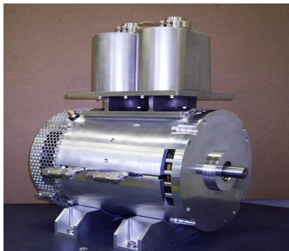
Figure III.8: Moteur supraconducteur Sumitomo. [32]
