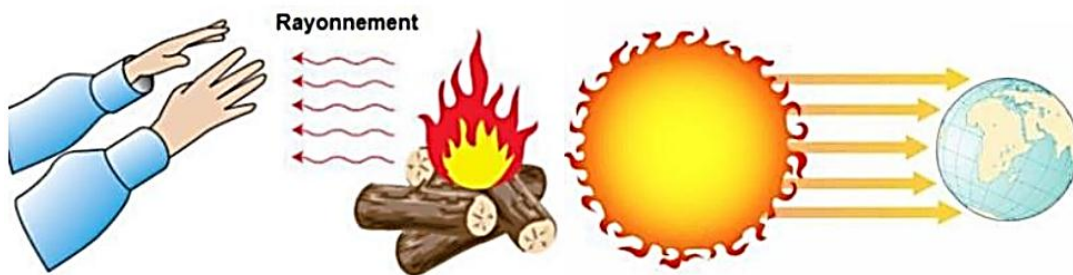
Fig. 2. 3. Schéma du phénomène de transfert de chaleur par rayonnement
