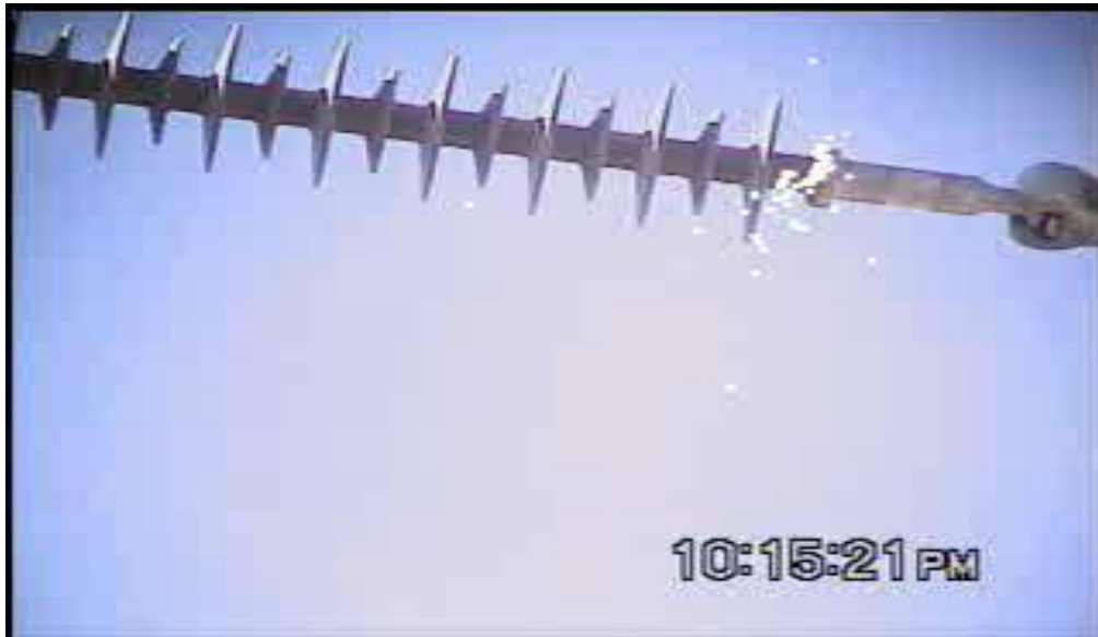
Figure II. 9. Illustration d'une décharge couronne au voisinage de l'électrode H.T d'un isolateur composite [39].
