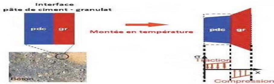
Figure II.6 : Mécanismes liés aux incompatibilités pâte-granulat. [18]
