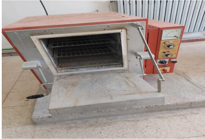
Figure IV.15 : Four à béton
