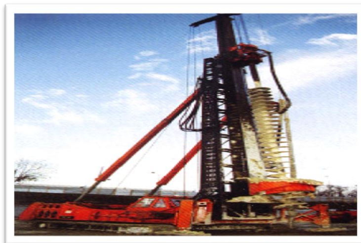
Figure -1.16 - Schéma de la tarière Soletanche Bachy
