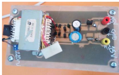
Figure (III.6) : Photo de carte d'alimentation des cartes de mesure.
