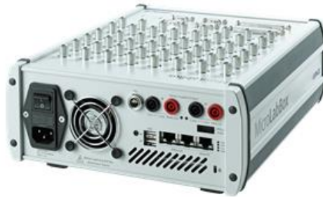
Figure (III.4) : Photo de la carte dSPACE MicroLabBox
