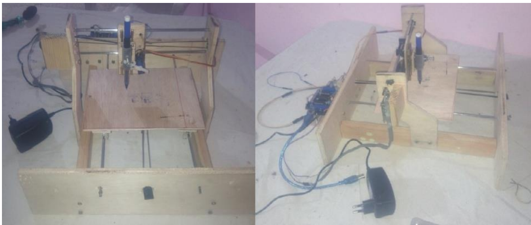
Figure 52: Le montage final de l'axe Z.
