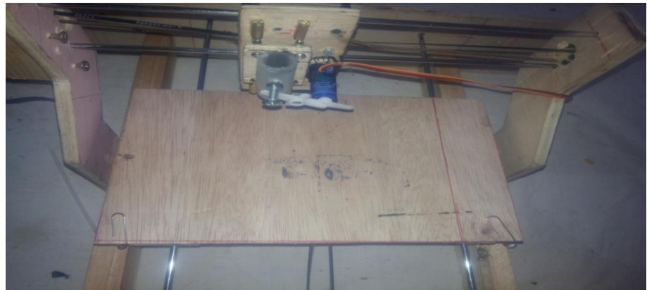
Figure 52: Le montage final de l'axe Z.
