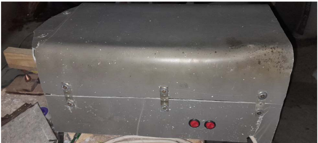
(Fig.III.26) : Montage de la Couverture sur la base.
