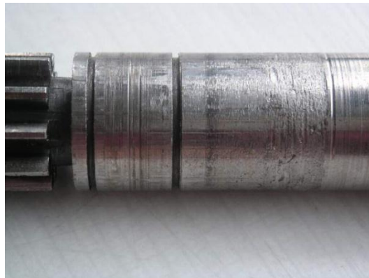
Figure III.1: Tourillon avec diverses traces d'usure.
