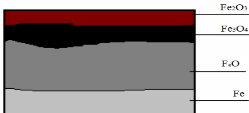
Figure III.4 : Formation des couches d'oxydes superposées sur la surface du fer à 625 °C après 24 h.
