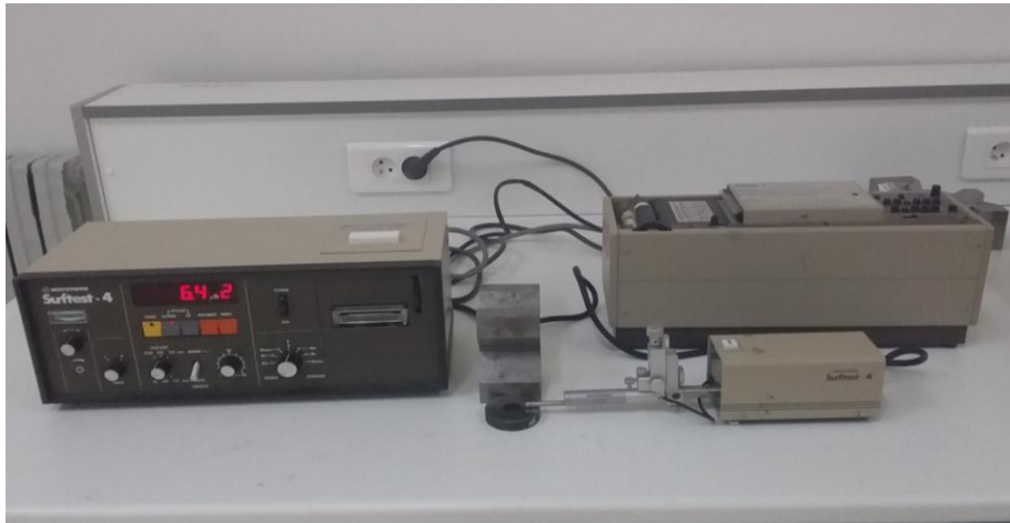
Figure IV.9 : Rugosimètre à stylet de type "MITUTOYO SurfTest - 4".
