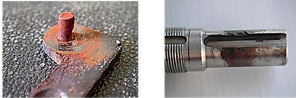
Figure III.3: Etat de surface présentant une usure par corrosion [24].
