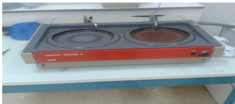
Figure IV.6 : Polisseuse de type Knuth-rotor-2.
