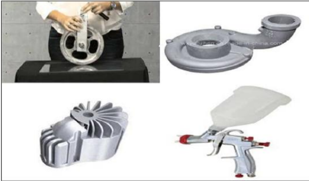
Figure 4 : Pièces moulées par gravité (3)
