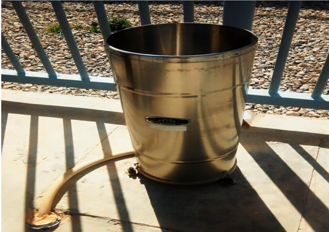
Figure III.11: capteur de mesure la quantité de pluie.
