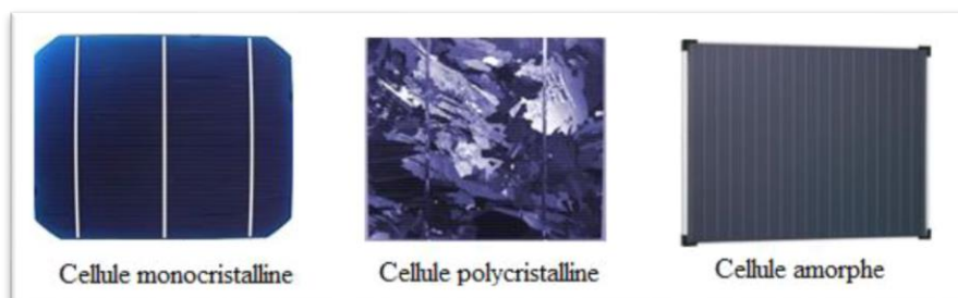
Figure.III.5 : Types des cellules photovoltaïques.
