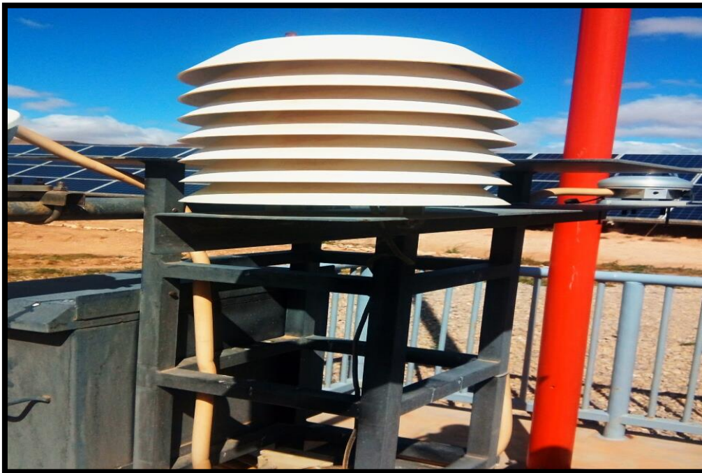
Figure III.10: capteur pour mesurer l'humidité en bas de la station.
