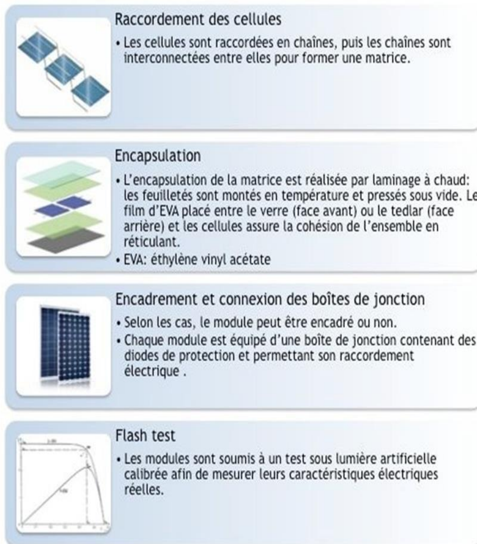
Figure III-14 : Assemblage des modules photovoltaïques
