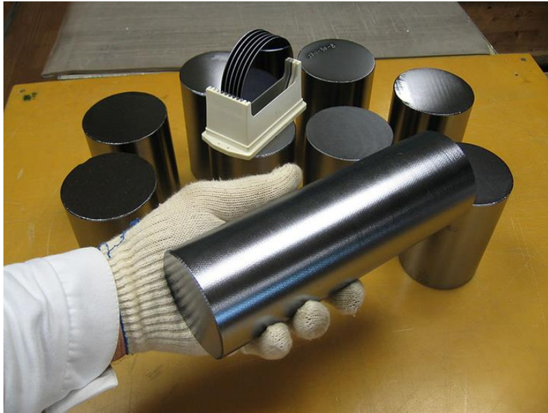
Figure II.7 : Technologie de dopage au silicium dans les réacteurs RBMK-1000[59]
