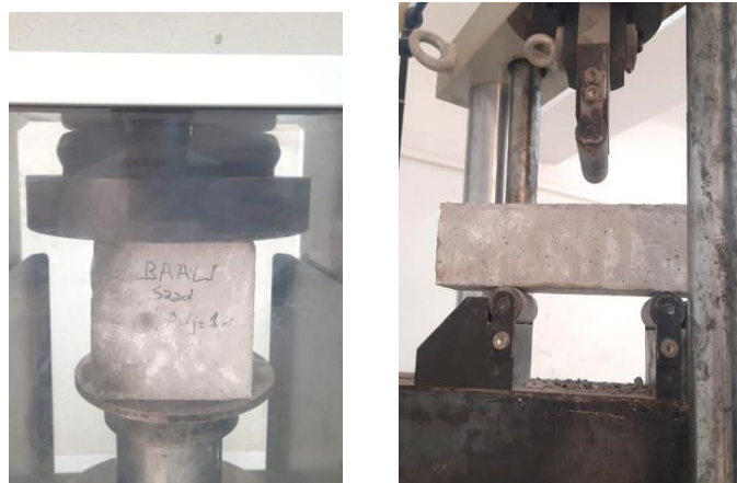
Figure IV-01 : Essai de compression et de traction par flexion.
