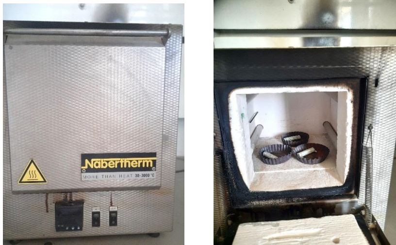
Figure III-15 : La pose de trois échantillons dans un four avec une température de 550°C.
