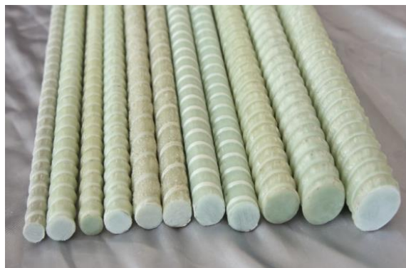
Figure II-01 : Les différents diamètres pour l'armature PRFV [19].
