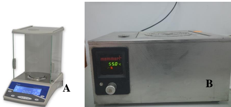
Figure III-12 : Appareillage de l'essai d'absorption : A) la Balance B) le Four.
