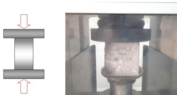
Figure III-10 : L'essai de compression pour une éprouvette cubique (15x15x15).
