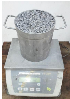
Figure III-08 : L'essai de masse volumique apparente de gravier.
