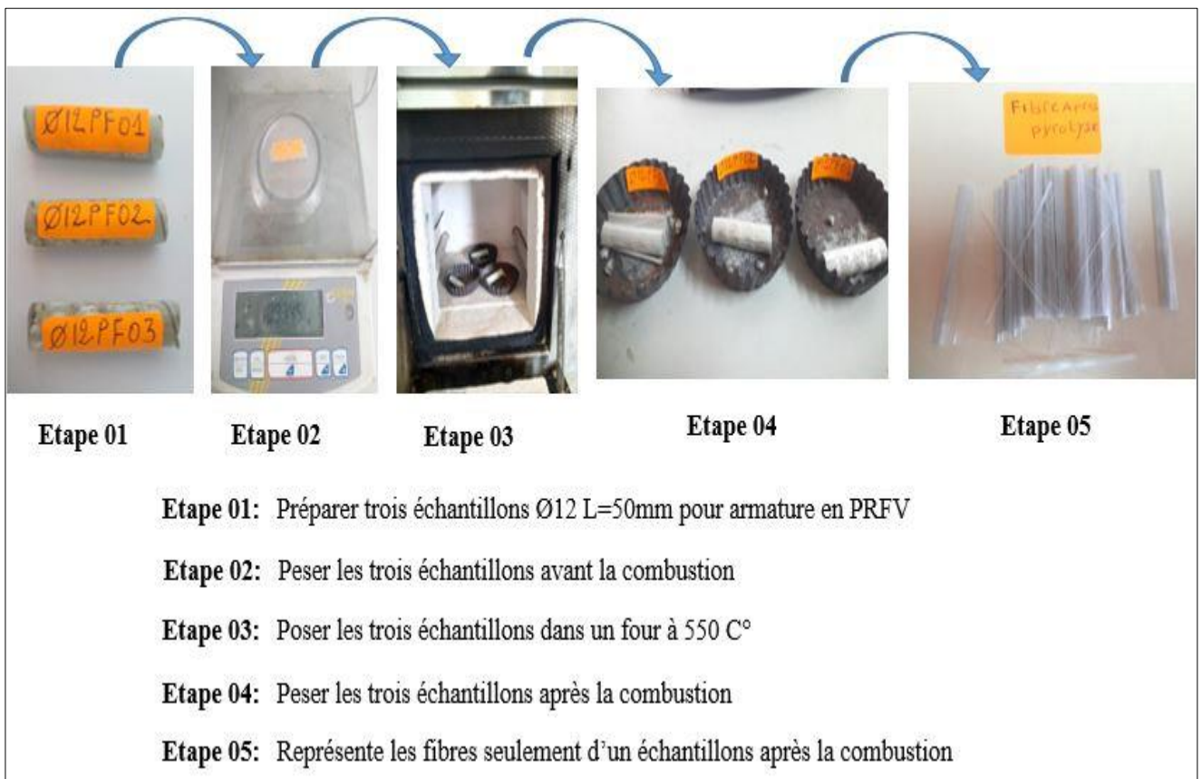
Figure IV-03 : Les étapes de l'essai perte au feu.
