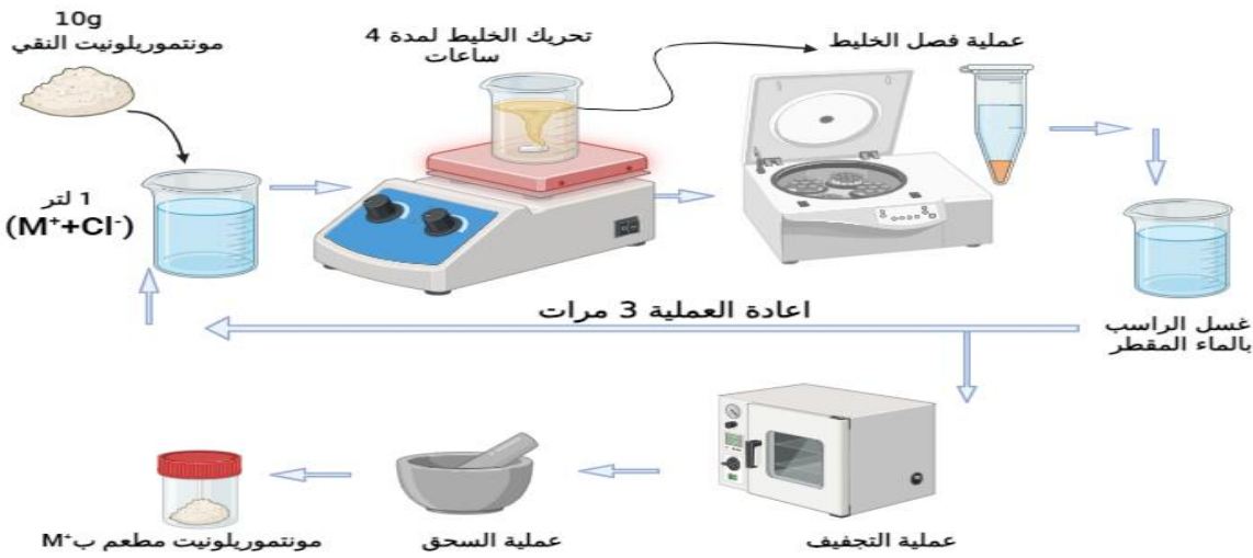
الشكل (2. IV): بروتوكول تحضير المونتموريلونيت المعدل MMt_{Mag}-M^+ (M^+ = Li^+, Na^+, K^+)
