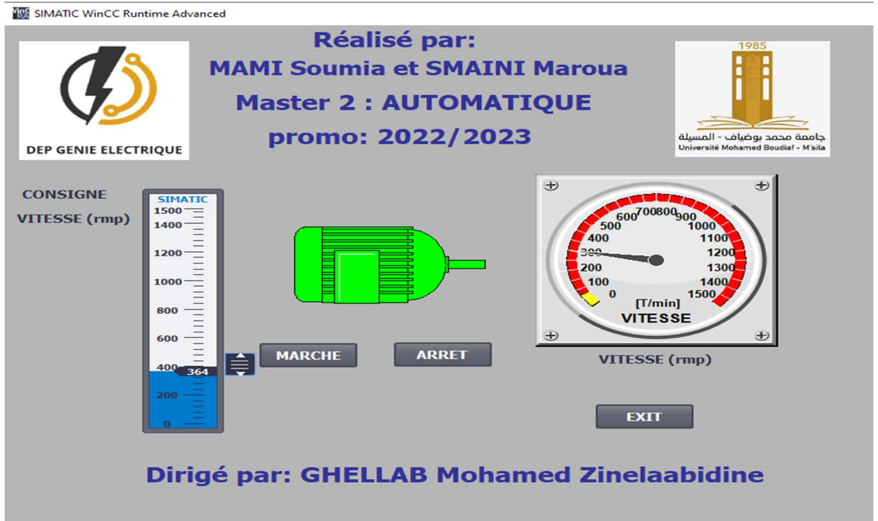
Figure IV.16 : Vue générale crée pour la HMI
