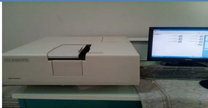
Figure 21: Spectromètre utilisé pour détermination de nitrite
