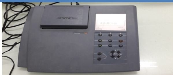
Figure 18: pH mètre utilisé dans les analyses de nos eaux d'irrigation
