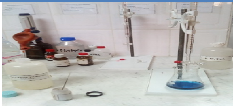
Figure 20: Etape de dosage de calcium ( \text{Ca}^{2+} ).
