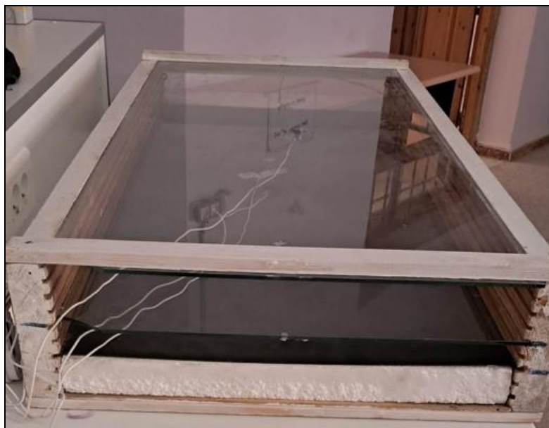
Fig.III.1. Vue générale sur le capteur solaire à air à double vitrage
