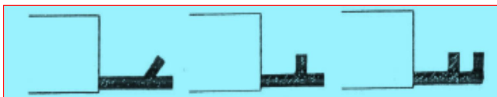
Figure .I.18 Forme des têtes de bobines d'un enroulement à deux plans
