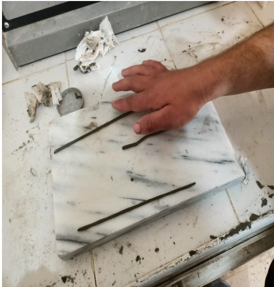
Figure _II 6 : Limite de plasticité au rouleau Figure _II 7 : Limite de liquidité à lacoupelle de Casagrande
