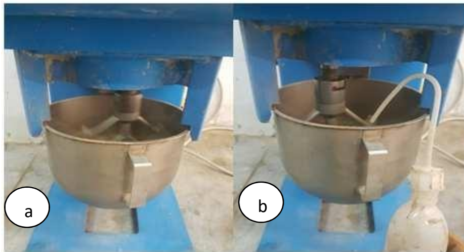
Figure _II 19 : Malaxage à sec (a), avec l'eau (b).
