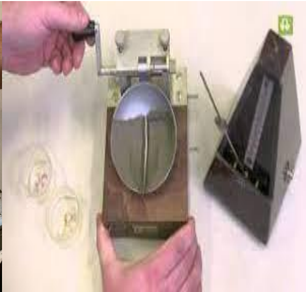
Figure _II 6 : Limite de plasticité au rouleau Figure _II 7 : Limite de liquidité à lacoupelle de Casagrande
