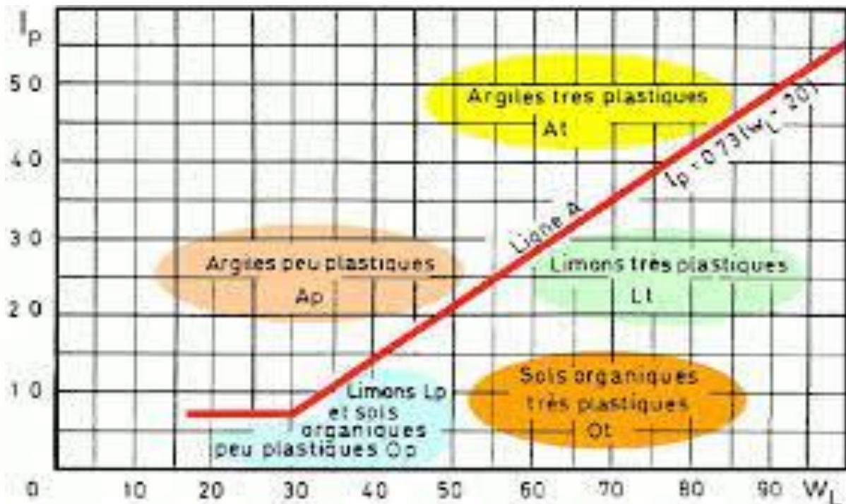
Figure II 9 : Classification LCPC des sols fins en laboratoire. Diagramme de plasticité.
