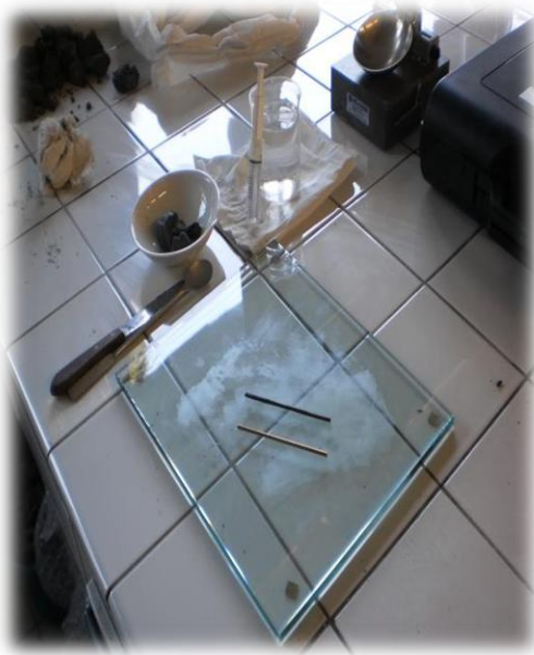
Figure II.9 : Limite de plasticité au rouleau Casagrande.
