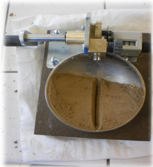
Figure II.10 : Limite de liquidité à la coupelle de Casagrande.
