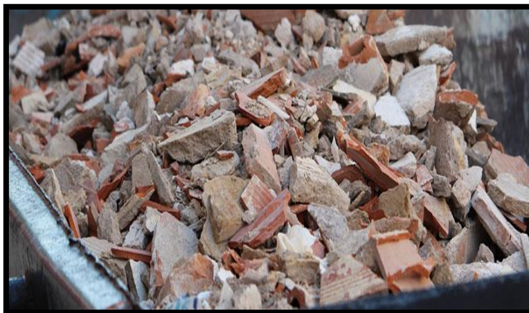
Figure II.2. Les déchets inertes
