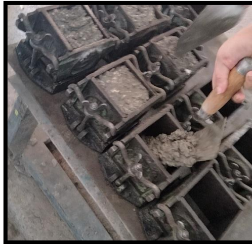
Figure III.7. Confection des bétons étudiés
