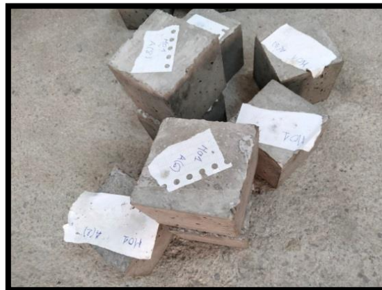
Figure III.8. Etiquetage des différents bétons
