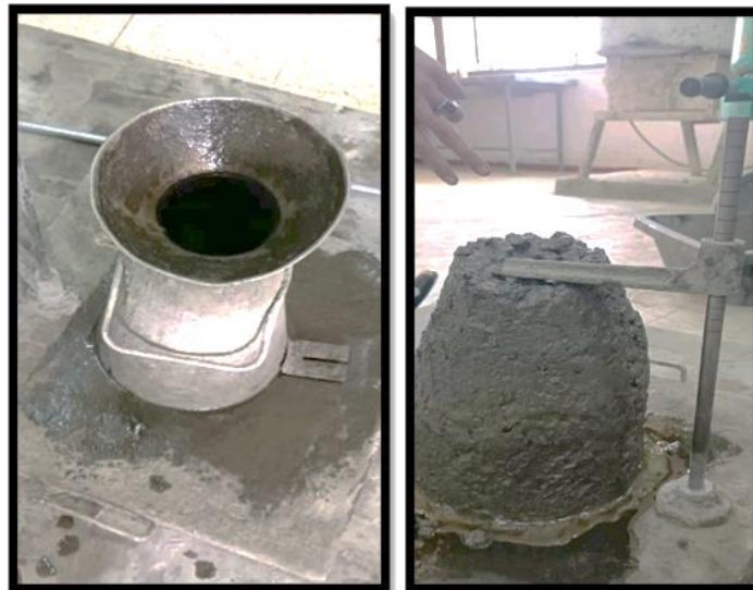
Figure III.9. Essai de cône d'Abrams.
