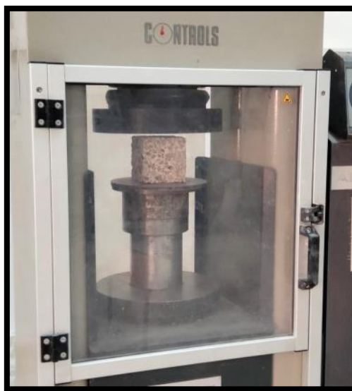
Figure III.16. Machine d'essai de résistance à la compression
