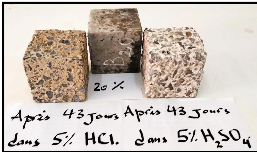
Figure III.13. Eprouvettes en bétons B10 et B20 après 43 jours d'exposition aux différentes solutions.
