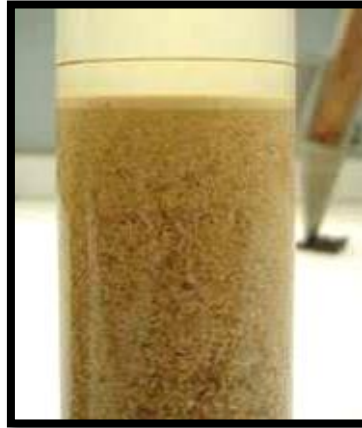
Figure I.8. Mesure de la propreté du sable.
