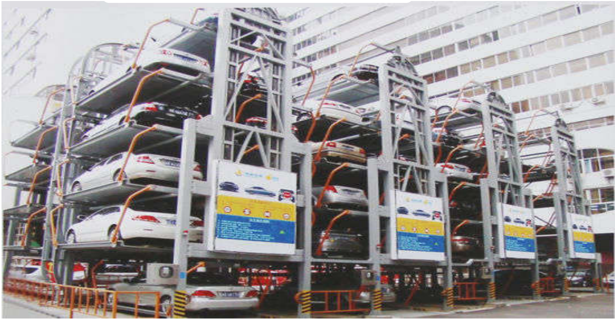
الصورة (37): موقف سيارات ذو طوابق ذكي
