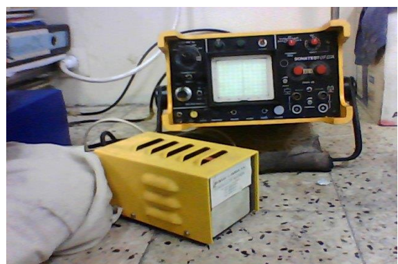
Fig.(IV.23) :calibre d'étalonnage V1 Fig.(IV.24) :Générateur d'ondes ultrason: USL32
