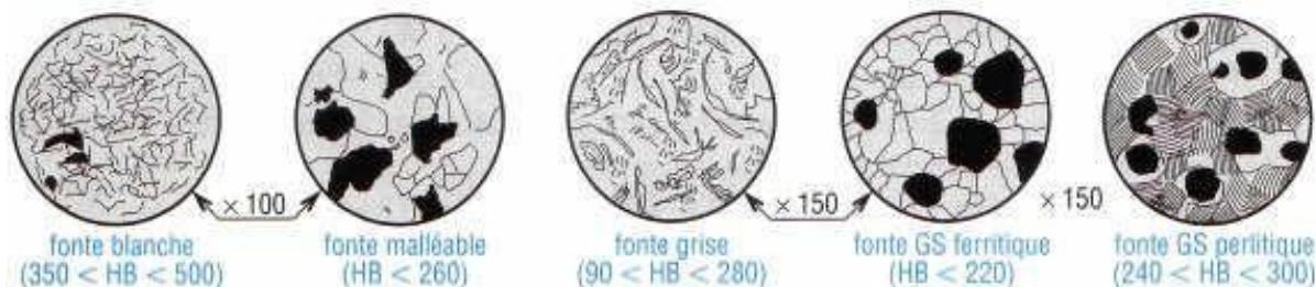
Figure I. 10. Microstructures des fontes usuelles.
