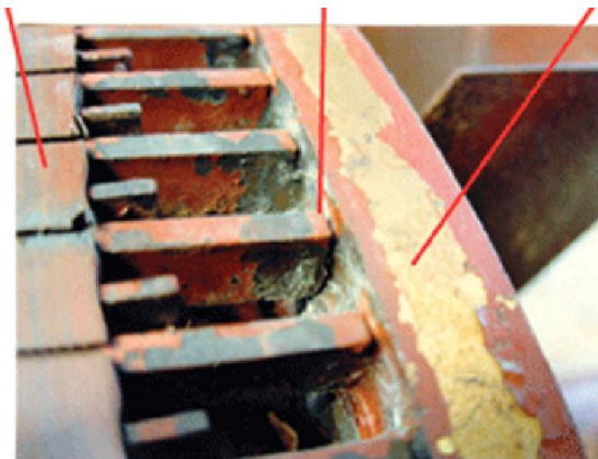
Figure 1.4: Exemple d'un défaut de cassure de barre d'un moteur asynchrone
