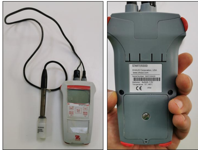
Figure 21 Photos du pH-mètre pour la mesure du pH des eaux de l'entrée et sortie de la station.
