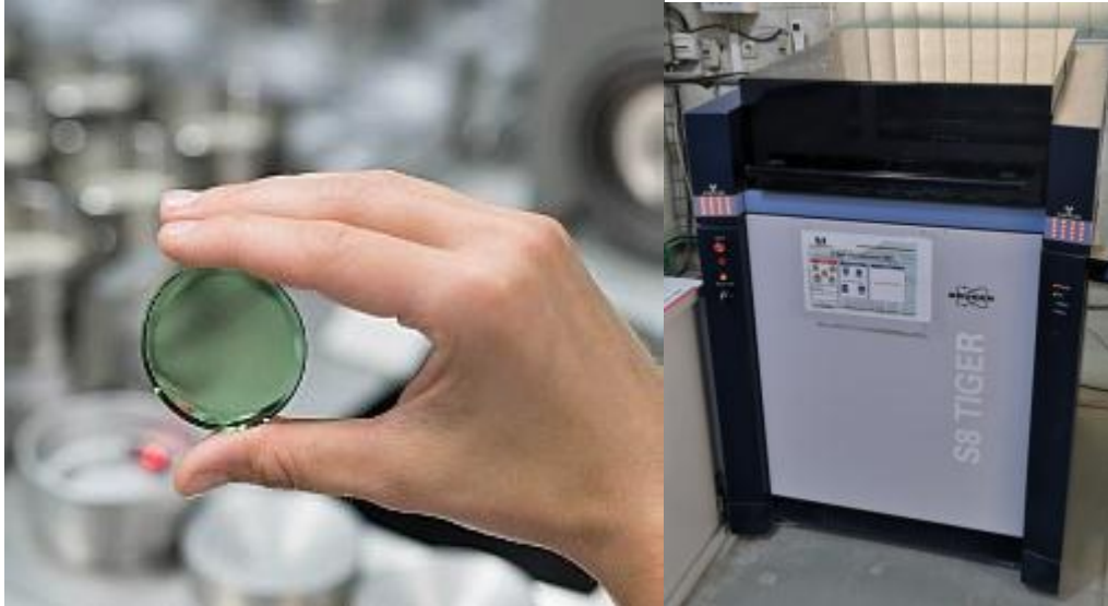
Figure 28 Photos d'une perle pour analyse de fluorescence x & de l'analyseur de fluorescence x (S8 TIGER de la marque BRUKER).
