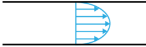
Figure 2.2 : Écoulement de Poiseuille [17]
