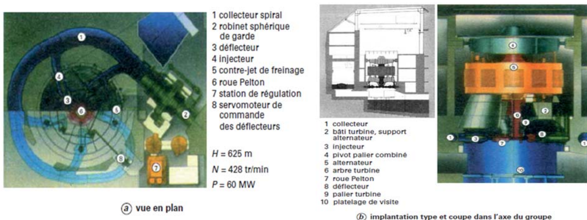
Figure 3.8 : Turbine Pelton à cinq jets et à axe vertical : centrale de Grand' Maison avec quatre turbines Pelton (France). [20]
