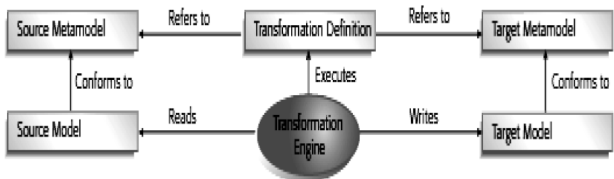
Figure 3.3: Concepts de base de la transformation de modèles [39].
