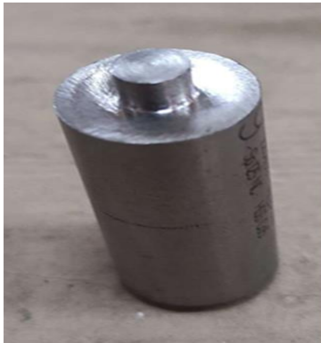
Figure IV.3 : L'outil FSP en HSS Cr5.
