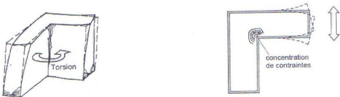
Figure.I-3- Influence de la forme sur la résistance à la torsion, concentration de contraintes dans les angles rentrants. [2]
