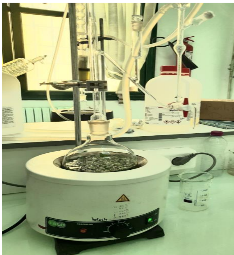
Figure 07 : Extraction des huiles essentielles par clevenger (photo personnelle).
