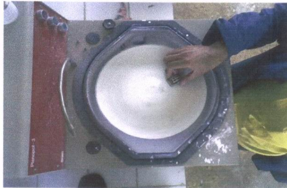
Figure IV.7: Le polissage final, en utilisant des pâtes diamantées sur un papier abrasif à grain 2000
