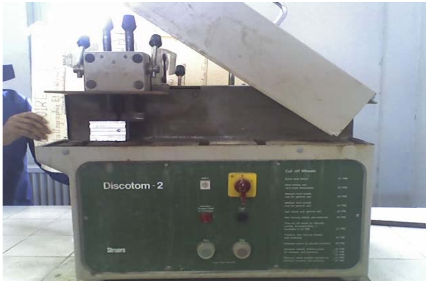
Figure IV.4 : Machine de tronçonnage
