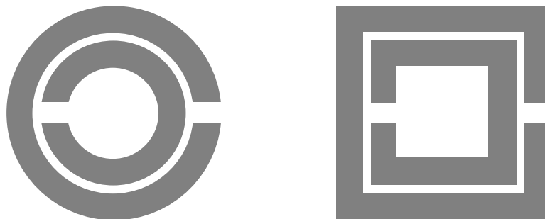
Figure II.11 Résonateur en anneau fendu (Split Ring Resonator (SRR))
