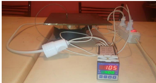
Figure II.2 : Image d'un thermocouple et régulateur de température.
