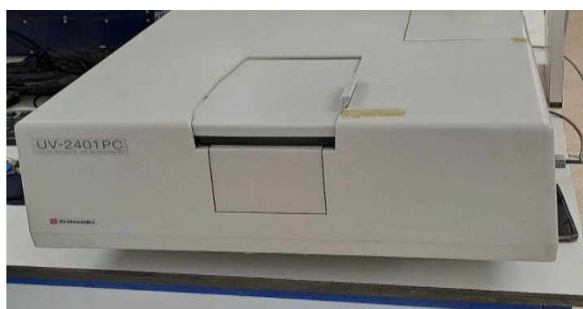
Figure II-3 : Spectrophotomètre UV-visible à double faisceau de type Shimadzu UV-2401P
