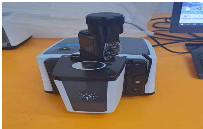
Figure II-4 : Spectromètre FT-IR de type Agilent Cary 630.
