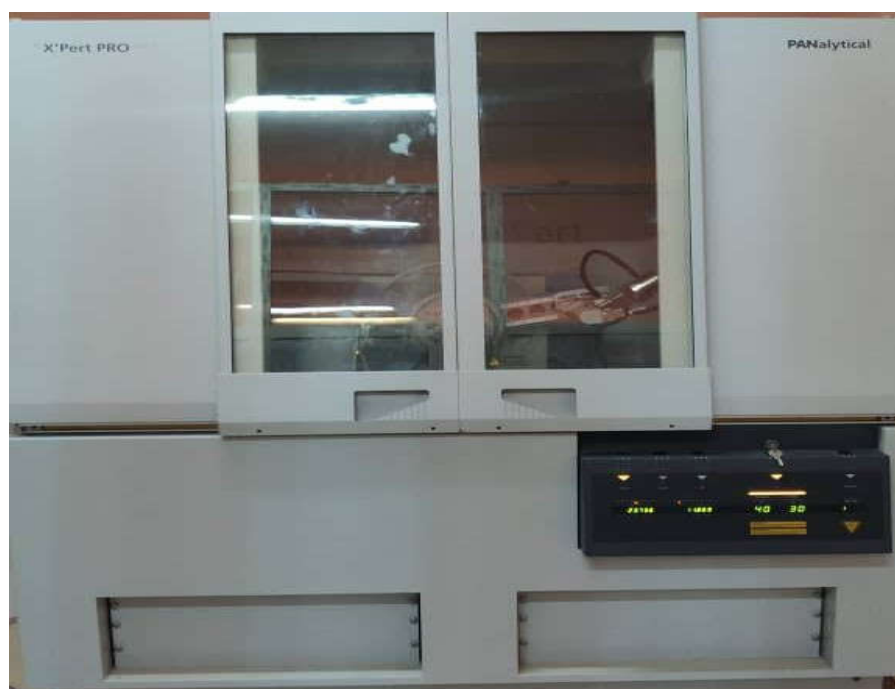
Figure II-6: Diffractomètre des Rayons X (X'Pert PRO PANalytical)
