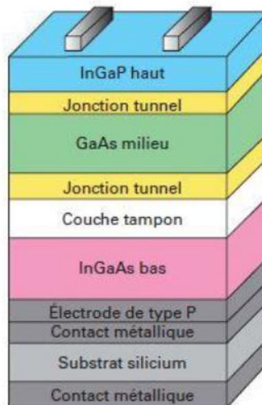
Figure I.7 : Vue schématique de la composition de la cellule à multijonction [16].
