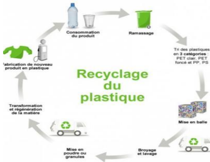
Figure N21:Schéma résumant les étapes du recyclage du plastique
