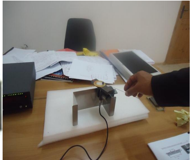
Figure III.4 : le montage d'expérience de mesure la vitesse de propagation
