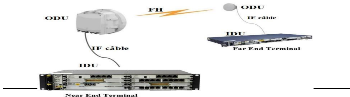
Figure II.4: Les équipements de système de transmission FH
