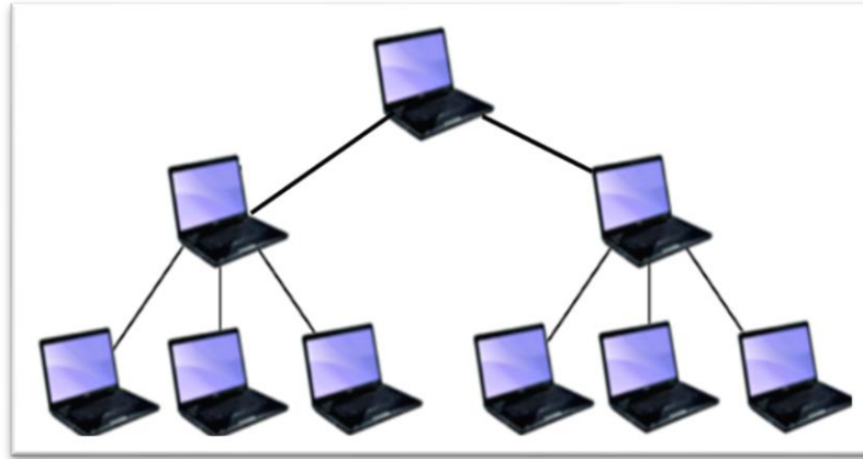
Figure 1.4 : Réseau en arbre.
