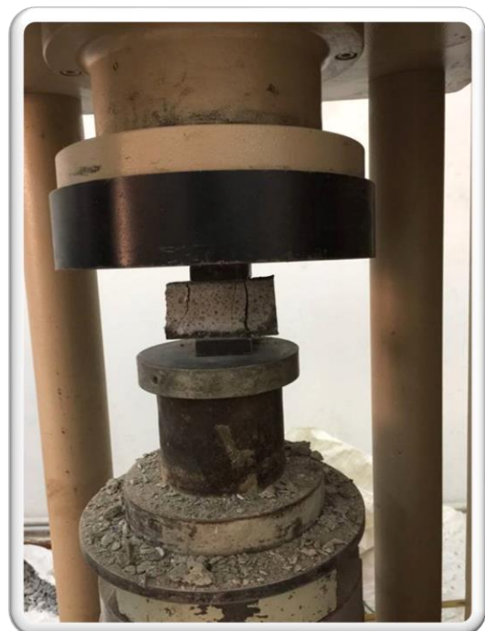
Figure (III.9) : L'appareil de compression.
