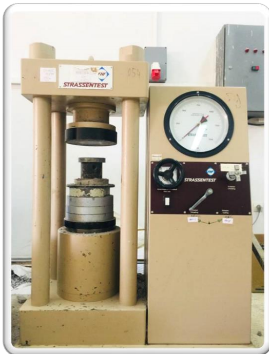
Figure (III.9) : L'appareil de compression.
