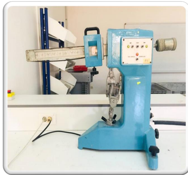
Figure (III.7) : L'appareil de résistance à la flexion.
