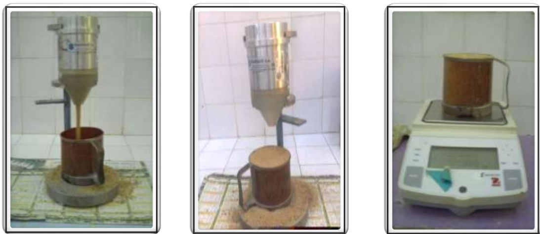
Figure (III.4) : Essai de détermination de la masse volumique apparente.
