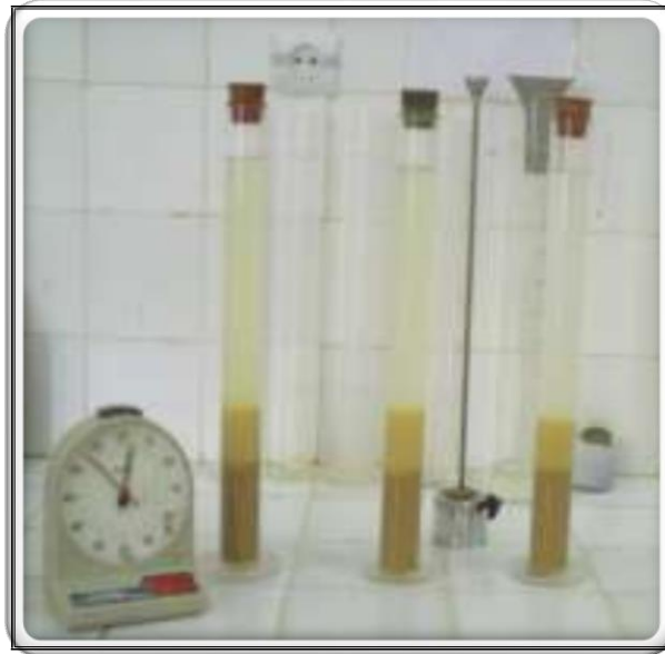
Figure (III.3) : Essai d'équivalent de sable.
