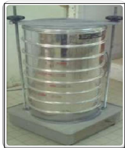
Figure (III.2) : Tamiseur électrique.
