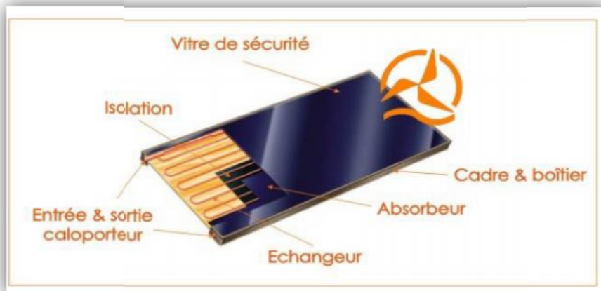
Figure I-21 : Capteurs solaires thermique à eau [18].
