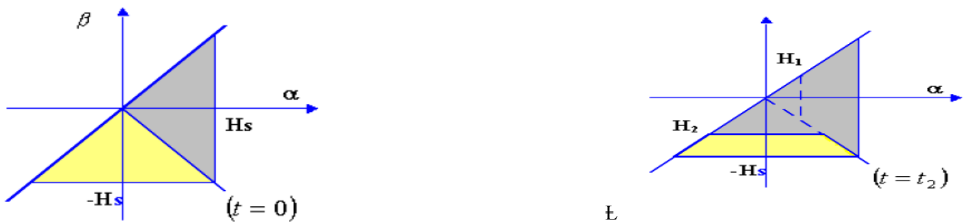
Figure (II. 15) : Le plan de Preisach sous l'effet de H_1 et H_2 si |H_2| > |H_1|
