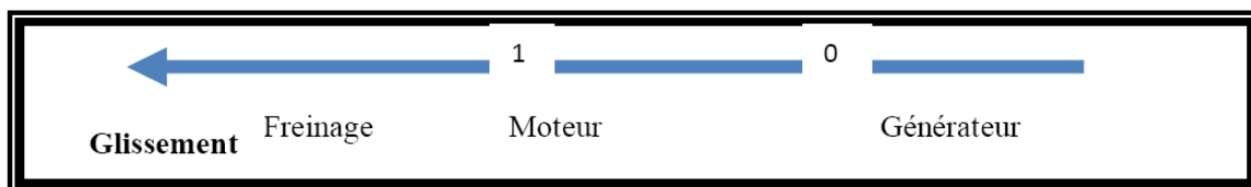
Fig. II.2 : Modes de fonctionnement suivant le glissement
