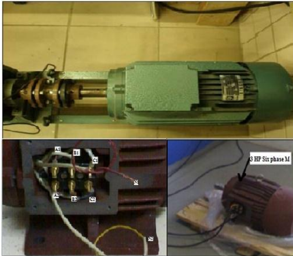
Fig. I.2 : la machine asynchrone double étoile (au-dessus) et MASDE avec illustration de plaque à borne (au-dessous droite et gauche) [7]
